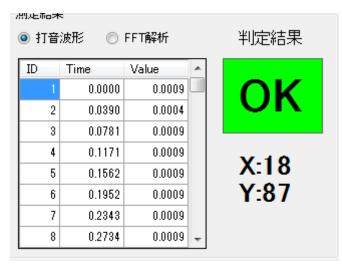
測定データファイルフォルダ(打音波形データ又は FFT 解結果)から データが読み込まれ表示されます。
