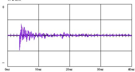
測定データフォルダにある、マイク入力の打音データ波形 (入力電圧 A/D 値) を表示するグラフです。縦軸が± 1 V の電圧で中心点をゼロとしています。 横軸は時間 (ミリ秒) で最大 40ms になります。 縦軸、横軸共に固定レンジになっています。
